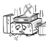
No coloque ningún objeto sobre el aparato (de lo contrario, impediría su ventilación adecuada): las ranuras de ventilación ubicadas en la cabina protegen a su aparato ante el sobrecalentamiento. No coloque ningún objeto, como un trozo de tela o una hoja de papel, sobre dichas hendiduras. Si coloca el aparato en un compartimento, deje una distancia de separación de al menos 10 cm por cada lado y de 20 cm en la parte delantera y trasera del aparato.
