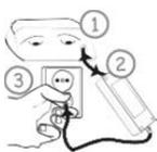
Conecte siempre, en primer lugar, el cable de la fuente eléctrica al aparato; a continuación, conecte el cable de alimentación al adaptador y, por último, el cable de alimentación a la toma corriente. Si no realiza las conexiones en el orden indicado, podría sufrir una descarga eléctrica.
