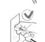
Cuando conecte o desconecte el cable de alimentación, sujete siempre el enchufe. Un cable dañado representa una fuente potencial de incendios o electrocuciones. No tire nunca del cable para desconectar el cable de red de la toma de corriente.
