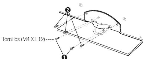
3. Atornille los dos tornillos (M4 x L12) en la posición ① y los otros tres (M4 x L12) en la posición ②.
