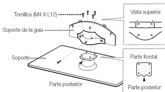
1. Conecte el soporte de la guía con el soporte mediante los cuatro tornillos (M4 x L12), tal como se muestra.
