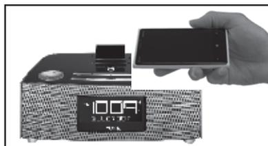
**REMARQUE :** Pour déconnecter votre appareil, il suffit de toucher à nouveau la zone NFC de l'unité. Pour coupler un appareil manuellement, reportez-vous à la section « Couplage d'un appareil via Bluetooth standard ».
