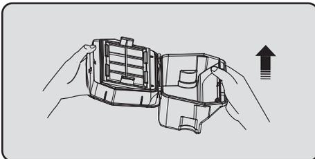
1. Open the baffle first, and then pour out the dust.
