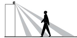
3.6 Bei Montage in einer Höhe von 2,50-2,75m über dem Boden, ist der Erfassungsbereich etwa 5m mit einem Betrachtungswinkel von 110°-10°. Wird der Sensor in einer geringeren Höhe montiert kann sich der Erfassungsbereich verringern.
