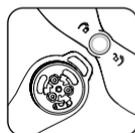
Los anillos plateados de la hélice se utilizan en motores sin puntos negros.
