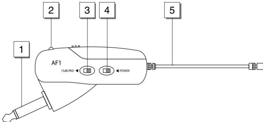
**Note :** Les caractéristiques des émetteurs AF1 et AG1 sont rigoureusement identiques, exception faite de l'angle du jack 6,35 mm. Seul l'AF1 est représenté dans les illustrations proposées par ce manuel.
