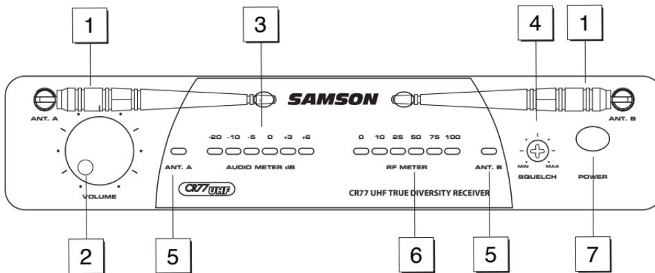
**mine le niveau du signal acoustique en sortie aux fiches de sorties symétrique et asymétrique, à l'arrière du rack. On obtient un niveau de référence lorsque le bouton est en position maximale (vers la droite).**
