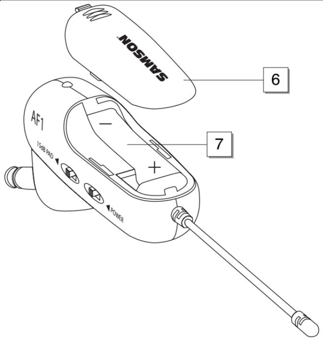
**3: 15 dB Dämpfung** – Bewegen Sie diesen Schalter in die Richtung des Pfeils, um den Ausgangspegel des AF1 oder AG1 um 15 dB zu bedämpfen, wenn Ihr Instrument ein zu starkes Signal ausgibt. Siehe Abschnitt "AirLine System einrichten und einsetzen" auf Seite 40 in diesem Handbuch..
