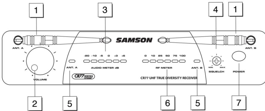
**1: Antennen (A und B)** - Die Antennenhalter haben einen Drehradius von 360°, um eine optimale Aufstellung zu erlauben. Bei normalem Betrieb sollten die beiden Antennen A (links) und B (rechts) senkrecht aufgestellt werden. Die Antennen lassen sich zum Transport des CR77 einschieben. Weitere Informationen erhalten Sie unter „Konfiguration und Betrieb der AirLine-Systeme“ auf Seite 40 dieses Handbuchs.
