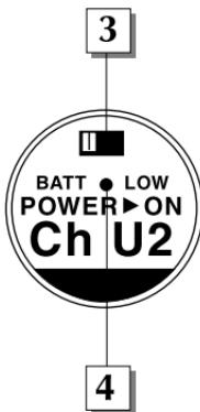
**3: Interruptor de encendido on-off** – Mueva este interruptor hacia la flecha para encender el AX1; desplácelo hacia el lado contrario para apagar la unidad. (Para alargar al máximo la carga de las pilas, asegúrese de apagar el AX1 cuando no lo utilice). Asegúrese de anular la señal audio en su mezclador exterior o amplificador antes de encender o apagar el AX1, ya que en caso contrario podría producirse algún tipo de petardeo audible.
