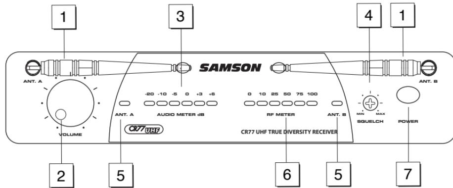
**1: Antennen (A und B)** - Die Antennenhalter haben einen Drehradius von 360°, um eine optimale Aufstellung zu erlauben. Bei normalem Betrieb sollten die beiden Antennen A (links) und B (rechts) senkrecht aufgestellt werden. Die Antennen lassen sich zum Transport des CR77 einschieben. Weitere Informationen erhalten Sie unter „Konfiguration und Betrieb der AirLine-Systeme“ auf Seite 53 dieses Handbuchs.
