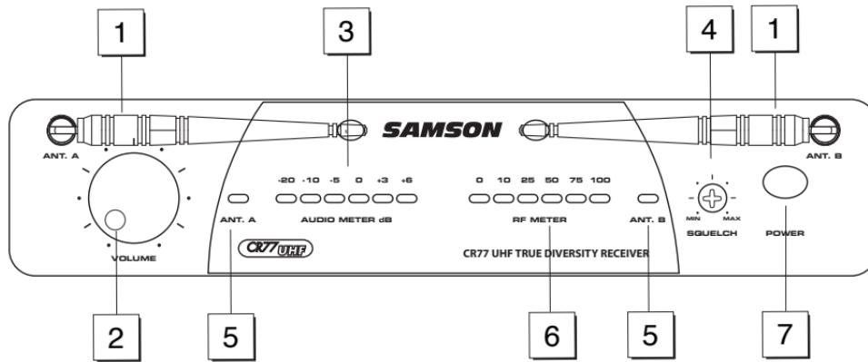
**1: Antennes (A et B)** - Les différents montages possibles des antennes permettent leur rotation complète pour obtenir une localisation optimale. En fonctionnement normal, l'antenne A (situated à gauche) et l'antenne B (situated à droite) doivent être placées en position verticale. Les deux antennes peuvent être repliées vers l'avant, pour faciliter le transport du récepteur CR77. Voir la page 35 de ce manuel, pour plus d'information sur l'installation et le positionnement des antennes.
