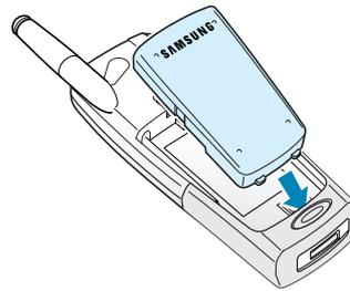
2. Deslice la batería hacia abajo hasta que se escuche un clic.
