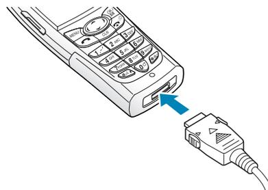
2. Enchufe el adaptador a una toma CA estándar. La batería comenzará a cargar inmediatamente, y la luz de servicio se encenderá y quedará en rojo mientras el ícono de la batería cambia.
