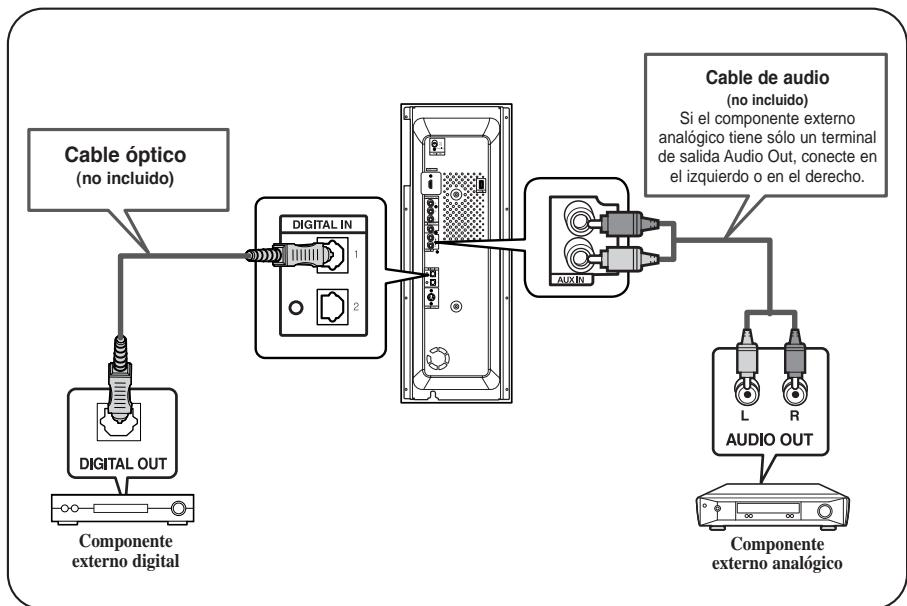
**1** Conecte la entrada digital 1 o 2 (ÓPTICA) de la unidad principal a la salida digital del componente digital externo.
