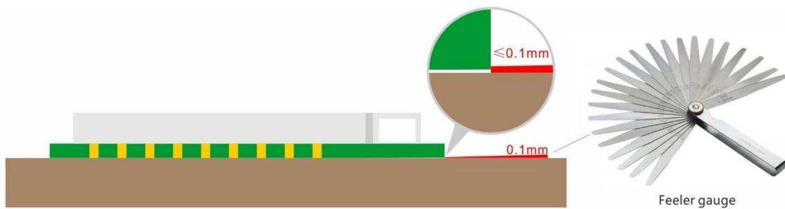
Module Bow and Twist:  $\leq 0.1\text{mm}$
