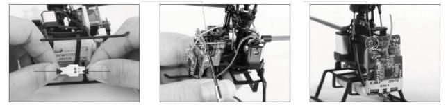
五合一控制器洗码:关闭发射机,接通五合一控制器电源,在编码对频按键开关上按住1-2秒,待接收机指示灯快速闪烁 后,清除编码成功,进入待对码状态;
