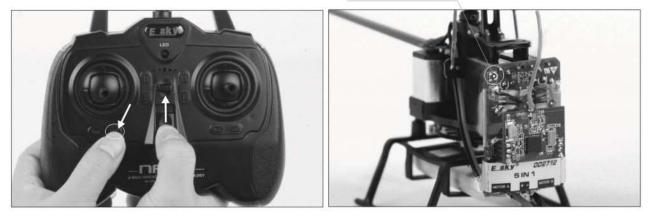
对码:按下发射机CH4 DOWN按钮不放,打开发射机电源,松开CH4 DOWN按钮,开始对码,待接收机指示灯闪烁后 熄灭,对码成功;
