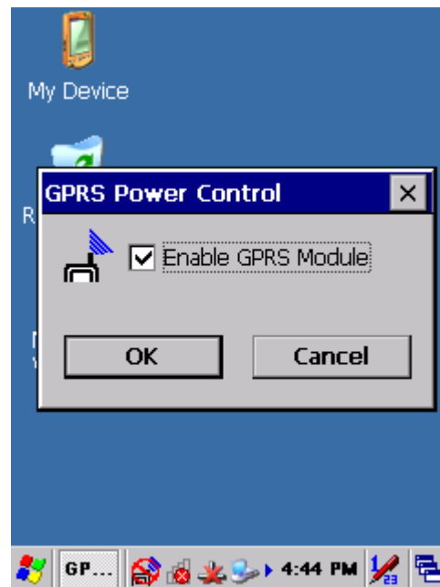
Figure A-4 Enable GPRS Module
