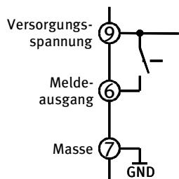
Ausgangsspannung: 0 (ausgeschaltet) oder Eingangsspannung (eingeschaltet)
