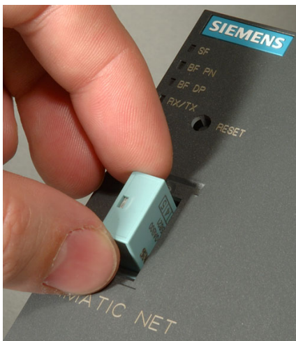
Bild 2-3 C-PLUG in das IWLAN/PB Link PN IO einsetzen und C-PLUG mit Hilfe eines Schraubendrehers aus dem IWLAN/PB Link PN IO entnehmen
