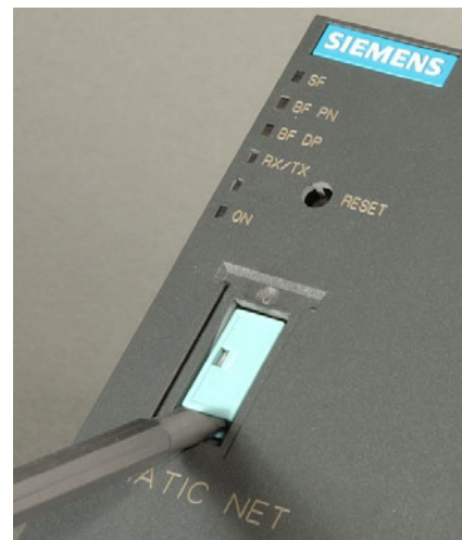
Bild 2-3 C-PLUG in das IWLAN/PB Link PN IO einsetzen und C-PLUG mit Hilfe eines Schraubendrehers aus dem IWLAN/PB Link PN IO entnehmen
