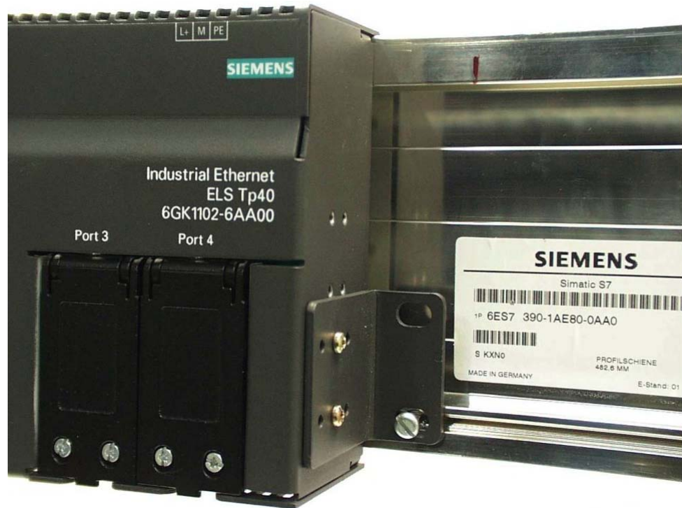
Figure 14. Installing an ELS TP40 on a SIMATIC S7-300 Standard Rail
