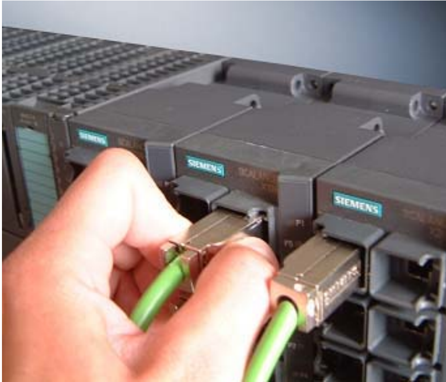
Bild 5-6 Entriegelung des RJ45 Plug
