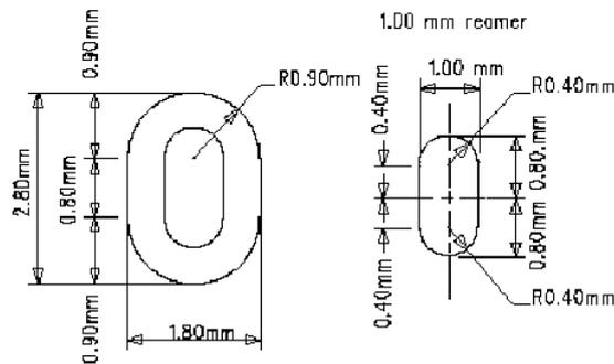
Tolerance  $\pm 0.1\text{mm}$
