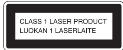
Cet appareil est certifié comme produit LASER DE CLASSE 1 conformément à la norme IEC60825-1 : 2001.
