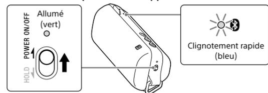
**2 Effectuez la procédure de pairage sur le périphérique BLUETOOTH pour détecter l'appareil.**
