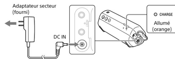
Le chargement démarre lorsque l'appareil est branché à une prise de courant via l'adaptateur secteur, et le témoin CHARGE (orange) s'allume. Le chargement dure environ 3 heures, puis le témoin s'éteint.
