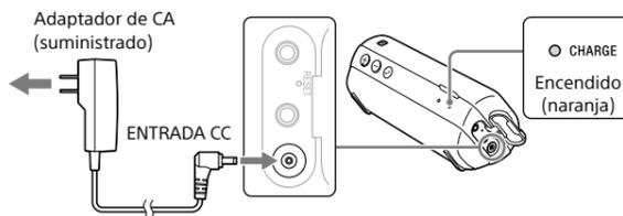
La carga comienza cuando conecta la unidad a una toma de CA a través del adaptador de CA y se enciende el indicador CHARGE (naranja). La carga finaliza en aproximadamente 3 horas y el indicador se apaga.
