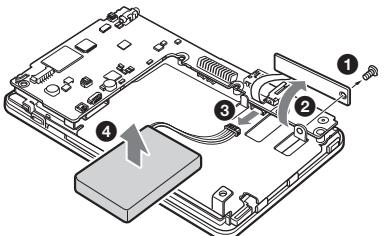
**5 Isolez la borne du connecteur en l'enroulant dans un ruban adhésif.****NV-U73T**
