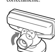
Coloque la marca del ángulo del objetivo de forma que quede alineada con el indicador azul del ángulo del objetivo.
