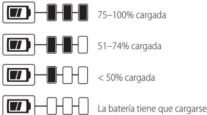
Para activar el indicador de carga, presione y sostenga el botón del indicador. Se iluminará una combinación de las tres luces LED verdes, que indicará el nivel de carga que queda. Cuando el nivel de carga está por debajo del nivel útil, el indicador no se iluminará, y la batería deberá recargarse.
