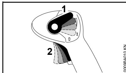
El gatillo de aceleración (2) puede trabarse en cualquier posición por medio de mover la palanca de ajuste (1).
