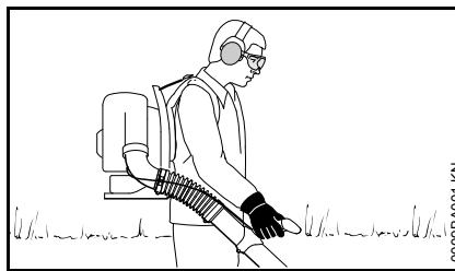
El soplador ha sido diseñado para usarse con una sola mano, con la mano derecha en el mango de control. Debe llevarse como una mochila con las correas del arnés sobre los dos hombros.
