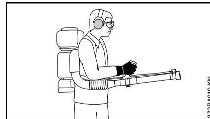
El atomizador ha sido diseñado para usarse con una sola mano, con la mano derecha en el mango de control. Debe llevarse como una mochila con las correas del arnés sobre los dos hombros.
