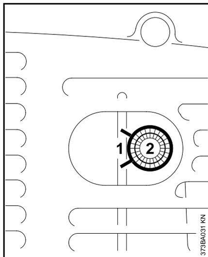
Si el motor pierde potencia o no funciona suavemente a máxima aceleración, revise el chispero del silenciador (si lo tiene).
