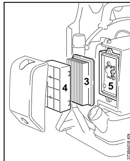
Los filtros de aire sucios reducen la potencia del motor, aumentan el consumo de combustible y dificultan el arranque del motor.
