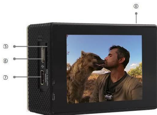
5. TF卡槽 6. USB接口 7. HDMI接口 8. 确认键
