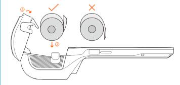
本机支持80mm热敏票据纸,标签纸,另外可选配支持黑标。 规格为 79±0.5mmר50mm
