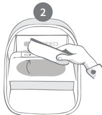
Entfernen Sie die schmutzige Schale für die Reinigung.
