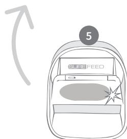
Vergewissern Sie sich vor dem Wiedereinsetzen des Napfs in den Futterautomaten, dass alle Oberflächen sauber sind und sich keine Futterreste unter dem Napf befinden. Nur so bleibt die Abdeckung beweglich und schließt den Napf vollkommen dicht.
