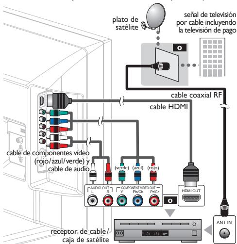
También puede conectar esta unidad al receptor de cable o caja de satélite, en lugar de a la toma de salida del video en componentes o HDMI (➔ p.25, 26) porque quizás tengan tomas de salida diferentes.
