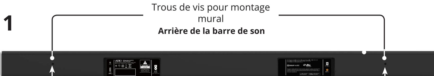
Insérez deux vis à montage mural dans les trous de montage mural et serrez-les à l'aide d'un tournevis Phillips.
