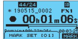
マークポイントが設定されている位置には、再生位置表示バーの下に **■** アイコンが表示されます。
