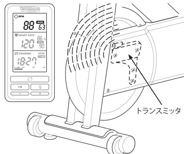
ディスプレイ下部にあるレシーバーより、遠隔測定チャエストベルトから送信される心拍数の信号を受信します。
