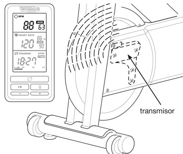
En la parte inferior de la pantalla hay un receptor que recibe las señales de la frecuencia cardíaca de la banda torácica telemétrica.
