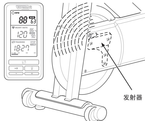
位于显示器下端的接收器可接收遥测胸带输出的心率信号。
