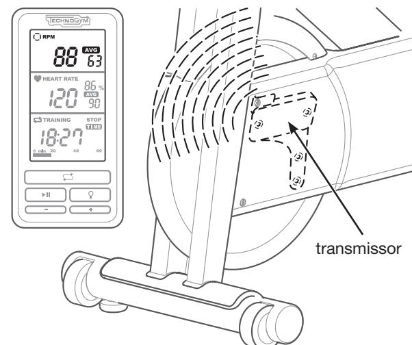
Na parte inferior do monitor há um receptor, que recebe os sinais da frequência cardíaca desde o cinto telemétrico aplicado ao tórax.
