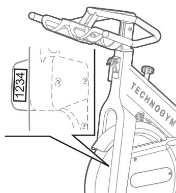
Si los códigos coinciden, sustituir las baterías del transmisor.
