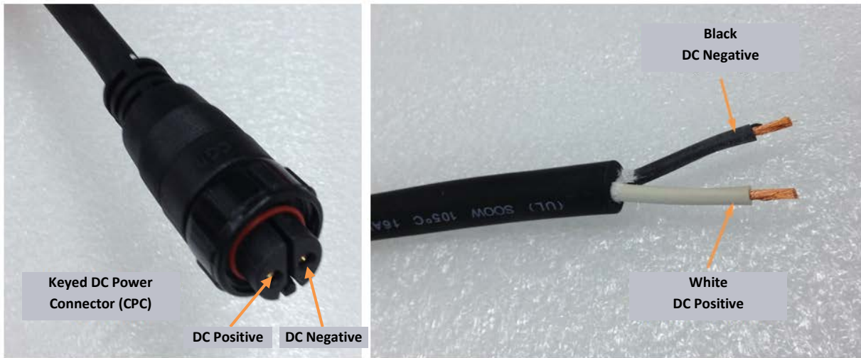
Figure 12: Polarité de connexion du connecteur CPC d'alimentation CC directe
