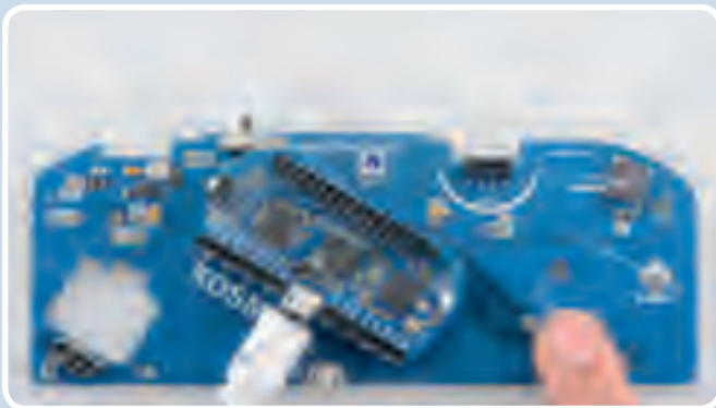
▲ Finger drückt auf linke Taste – NeoPixel leuchtet blau
