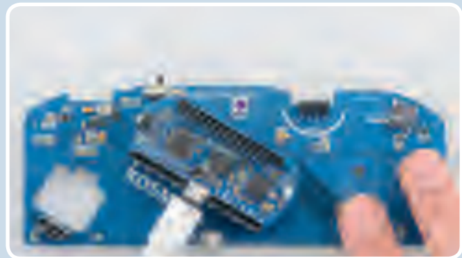
▲ Zwei Finger drücken auf beide Tasten – NeoPixel leuchtet lila
