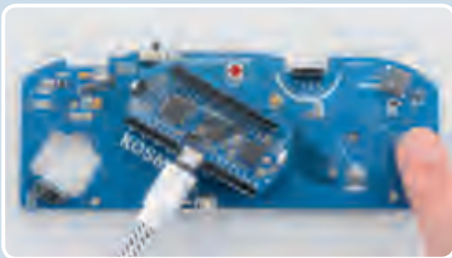
▲ Finger drückt auf rechte Taste – NeoPixel leuchtet rot
