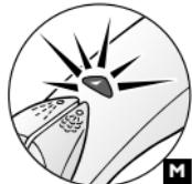
**NB. Når det automatiske stop er i funktion, er det normalt at termostatlamperen er slukket.**
