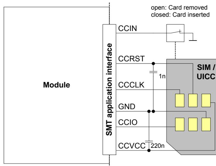
**Figure 4:** UICC/SIM/USIM interface
