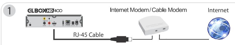
Connectez la GLBoxHD 400 à votre modem avec le câble RJ-45 | Pour plus de détails lisez la section Paramètres réseau.
