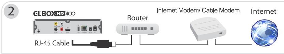
Connectez la GLBoxHD 400 à votre routeur via un câble RJ-45 | Pour plus de détails lisez la section Paramètres réseau.
