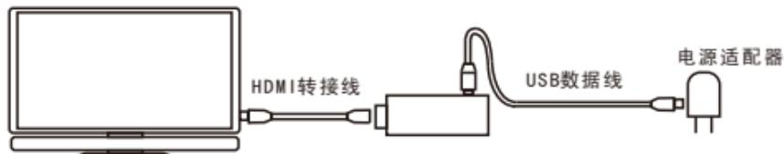
2. 使用USB数据线的Micro端口插入多屏分享器。数据线另一接口插入电视USB接口为其供电。（如电视无USB接口，可接入手机或其它设备的5V电源适配器。）接入电源后多屏分享器会自动开机。
