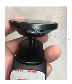
Type-C 供 电接口 Type-C power supply interface
