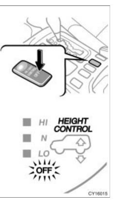
(d) Turning off the rear height control air suspension
