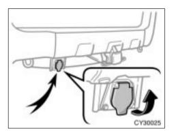
TOWING CONNECTOR FOR TRAILER LIGHTS
