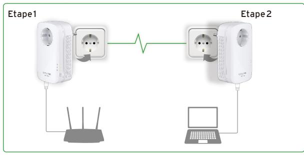
Remarque: Les adaptateurs CPL doivent être utilisé sur un circuit électrique commun et par deux ou plus. Le premier, connecté au routeur et les autres branchés dans les pièces ou vous avez besoin d'une connexion réseau.
