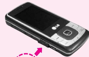
Por favor asegurese de que el logo de LG este mirando hacia abajo y el lado 'B' este mirando hacia arriba antes de insertar el cargador o cable de datos en el puerto de carga de su teléfono.
