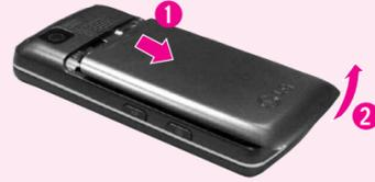
2. Levante la batería (1) y retírela (2) del teléfono, como se muestra.
