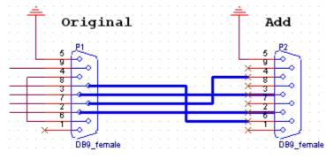
Original Pin 2  $\leftrightarrow$  Add Pin 2 Original Pin 3  $\leftrightarrow$  Add Pin 3 Original Pin 7  $\leftrightarrow$  Add Pin 4 Original Pin 8  $\leftrightarrow$  Add Pin 6
