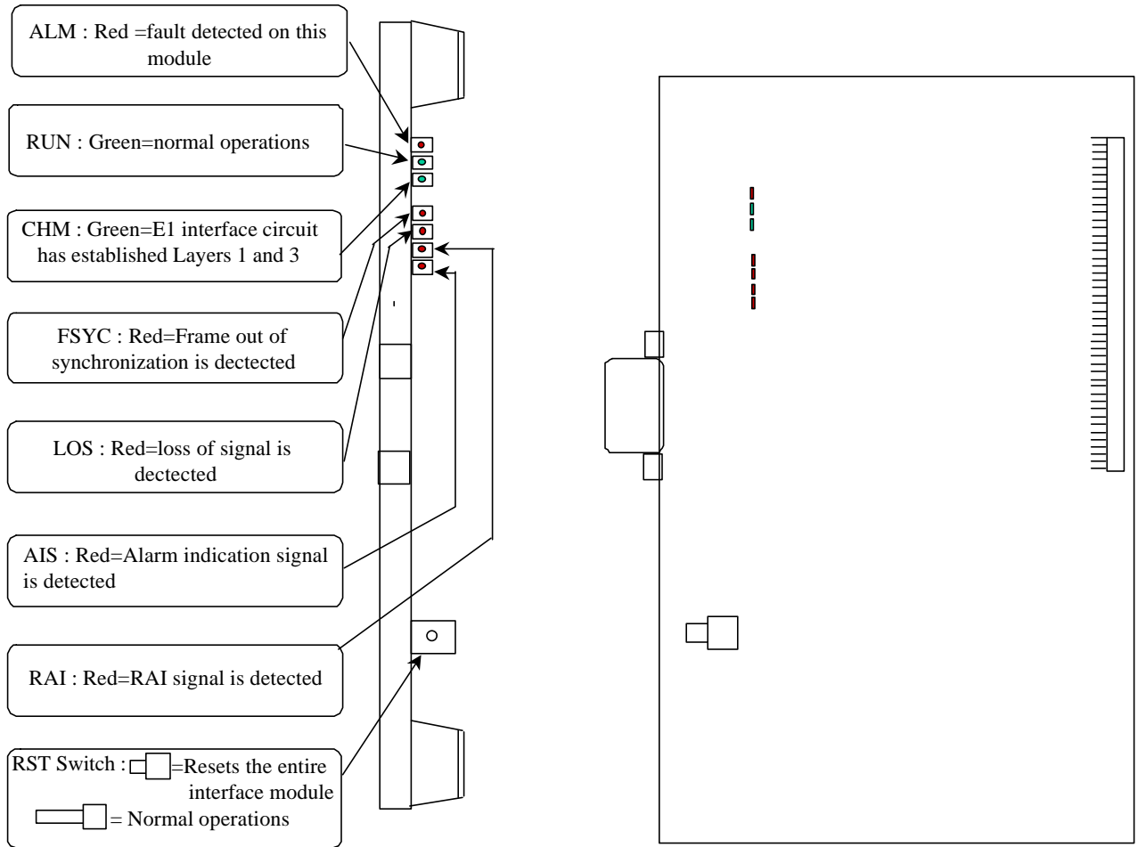
Figure 2-6: E1IF Module Layout
