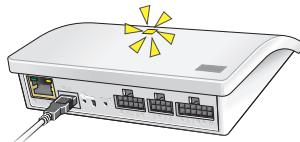
インターフェースを主電源に接続します。LEDが黄色く点滅したらインターフェースは設定準備OKです。
