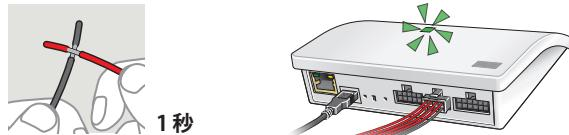
選択した製品をコントロールするダブル入力端子のワイヤーをショートさせます（1秒）。LEDが緑色に点滅し、製品がインターフェースの入力端子に割り当てられるまでに1分ほど掛かります。
