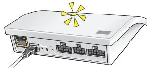
Conecte la interfaz a la corriente eléctrica. Cuando el diodo luminoso parpadea en amarillo, la interfaz está lista para su configuración.
