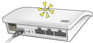
Brancher l'interface au réseau électrique. Lorsque la diode clignote en jaune, l'interface est prête pour la configuration.
