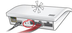
付属のワイヤー束を入力端子に接続します。インターフェースの裏面にあるRESETボタンを先のとがったもので短く(1秒)押します。LEDが白く早く点滅します。ここで、2分以内にステップ15を実行しなければなりません。
