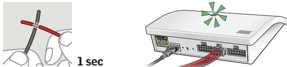
Ponga los cables en cortocircuito (1 segundo) en la doble entrada que es para controlar el/los producto(s) elegido(s). Puede pasar hasta 1 minuto antes de que el diodo luminoso parpadee en verde y el/los producto(s) sea(n) asignado(s) a la terminal de entrada de la interfaz.
