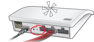
Conecte el conjunto de cables suministrado a la terminal de entrada. Presione brevemente el botón RESET en la parte trasera de la interfaz (1 segundo) con un objeto puntiagudo. El diodo luminoso parpadeará en blanco rápidamente. El paso 15 debe llevarse a cabo en un máximo de 2 minutos.
