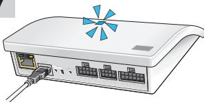
Cuando el diodo luminoso azul está encendido, la interfaz está configurada como repetidora.
