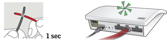
Ponga los cables en cortocircuito (1 segundo) en la doble entrada que es para controlar el/los producto(s) elegido(s). El diodo luminoso parpadeará en verde.
