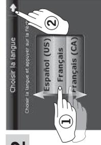
Choisir la langue. Tourner, en effleurant avec votre doigt, la roue affichée dans le sens des flèches ①.
