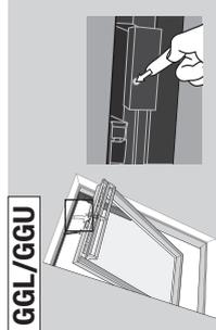
Se hai perso il tuo control pad oppure se le batterie è scarica, puoi chiudere la finestra premendo un tasto sulla finestra. Vedi come chiudere la tua finestra (a seconda del modello) senza il control pad nelle istruzioni complete sul sito [www.velux.com](http://www.velux.com).
