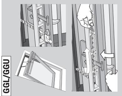
Im Falle eines Stromausfalls können Sie Ihr Schwingfenster durch Aushängen der Kette an der Lüftungsklappe des Fensters manuell geschlossen werden.
