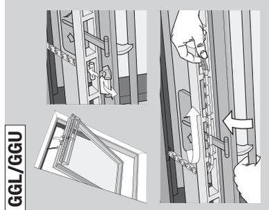
In caso di interruzione di corrente, puoi chiudere la tua finestra per tetti con apertura a bilico manualmente staccando la catena dall'alletta di ventilazione. Vedi come chiudere la tua finestra manualmente (a seconda del modello) nelle istruzioni complete sul sito [www.velux.com](http://www.velux.com).
