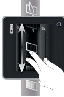
U bedient alle producten door te tikken op de pictogrammen/knoppen of door de schuifregelaar te slepen of te tikken op de balk in het scherm.
