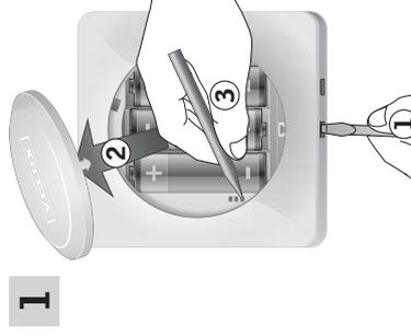
Lösen Sie den Batteriedeckel durch das Drücken des Druckknopfes mit einem Schraubendreher wie in der Abbildung gezeigt **1**, **2**.
