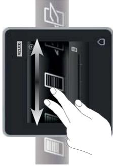
Управлявате всички продукти, като чуквате върху иконите/ бутоните или като дърпате плъзгача и чуквате върху лентата на дисплея.
