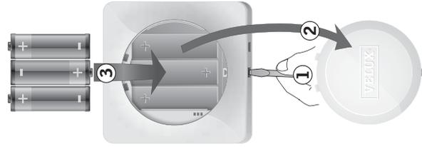
Antes de accionar los productos VELUX, éstos deben estar registrados en el panel de control. Quite la tapa de la batería presionando el orificio con un destornillador, tal como se muestra en la imagen ①, ②. Introduzca las baterías (tipo AA/LR6) ③.
