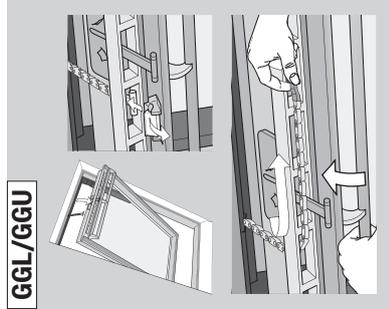
V případě výpadku el. energie lze kyvné okno zavřít ručně odpojením řetězu na ventilační klapce okna. Informace o ručním zavření okna najdete v kompletních pokynech pro ovládací panel na adrese [www.velux.com](http://www.velux.com).
