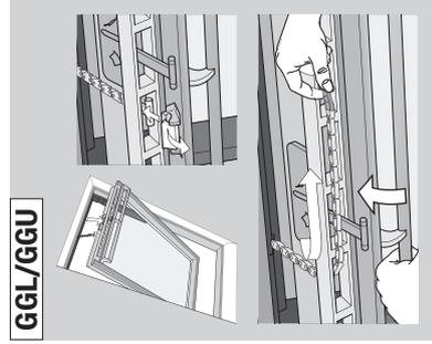
En el caso de problema de suministro de corriente, su ventana giratoria puede cerrarse manualmente si desengancha la cadena del motor. Puede acceder a más información sobre el accionamiento de la ventana manualmente, dependiendo del modelo de ventana, en las instrucciones completas del panel de control en [www.velux.com](http://www.velux.com).
