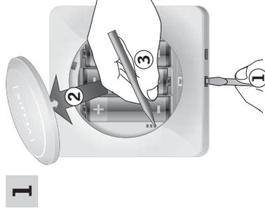
Quite la tapa de la batería presionando el orificio con un destornillador, tal como se muestra en la imagen **1**, **2**.
