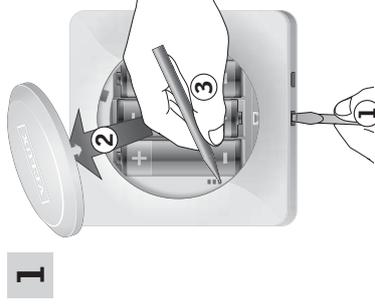
Retirer le cache des piles en appuyant sur le bouton avec un tournevis, comme le montre l'illustration **1**, **2**.
