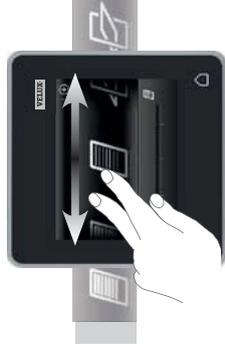
Sie bedienen alle Produkte durch Tippen der Symbole/Tasten oder durch Ziehen des Schiebereglers oder Tippen des Balkens auf dem Display.
