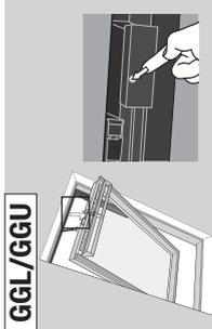
Ако контролният панел е изгубен прозорецът може да бъде затворен ръчно чрез натискане на един бутон на прозореца.
