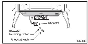
Fig. 17 Attach the fan rheostat.
