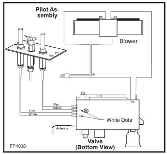
Fig. 51 Comfort Valve wiring diagram.
