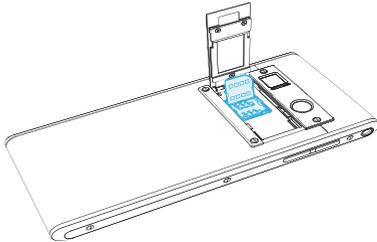
3. Finalement, fermez la trappe de la carte SIM et verrouillez-la (voir l'illustration), Puis replacez le couvercle arrière et faites-le glisser en place.
