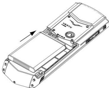
4. Abaissez la partie inférieure de la batterie dans le compartiment à batterie jusqu'à ce qu'elle s'emboîte bien en place.
