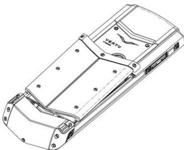
3. Insérez la batterie en l'inclinant légèrement de manière à ce que les contacts métalliques de la batterie s'alignent avec les contacts métalliques de votre téléphone.
