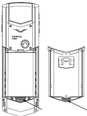
6. Poussez doucement le haut du couvercle de la batterie jusqu'à ce qu'il s'enclique en place.
