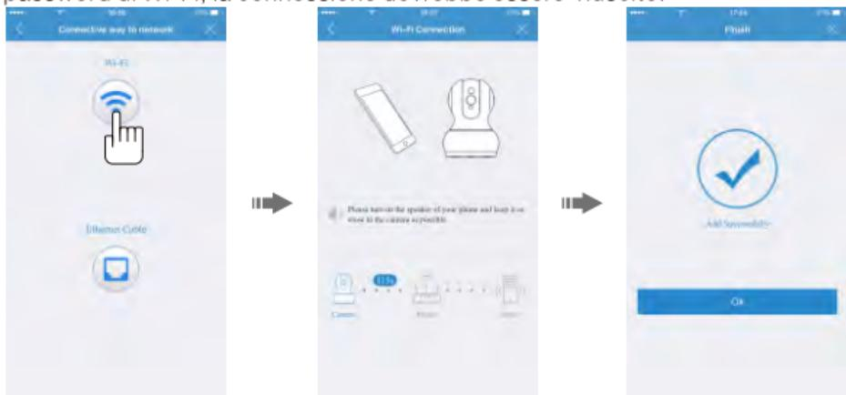
**Nota:** ① Premere il pulsante RESET, tenere premuto per 1-2 secondi per entrare nella configurazione Wi-Fi, premere a lungo 10-12secondi per ripristinare le impostazioni di fabbrica.
